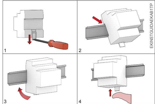
Per lo smontaggio dell'apparecchio, assicurarsi di avere scollegato le uscite e di avere disinsertito il morsetto bus dal suo alloggiamento. Mediante un cacciavite far scorrere verso il basso il dispositivo di blocco e rimuovere l'apparecchio dalla guida profilata.
