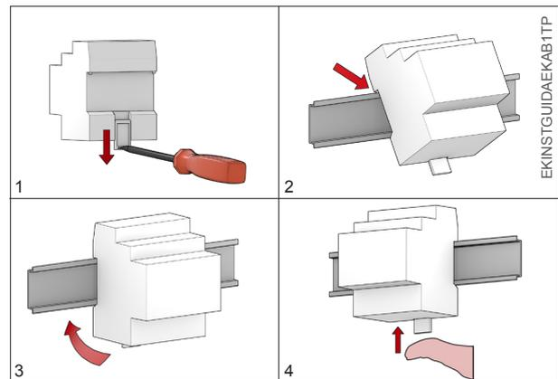
Per il montaggio dell'apparecchio sulla guida procedere come segue:
