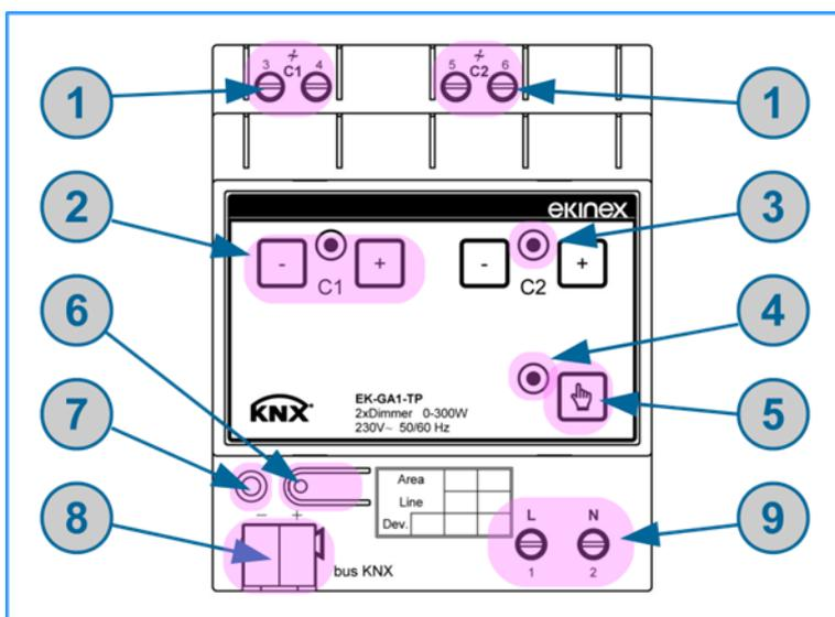
**Fig. 1 - Elementi di commutazione, visualizzazione e connessione**
