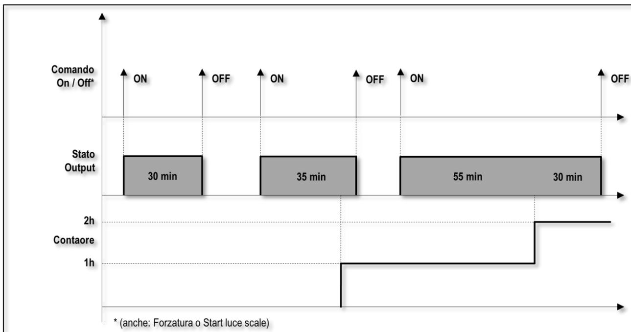
Fig. 15 - Contatore tempo di funzionamento / energia
