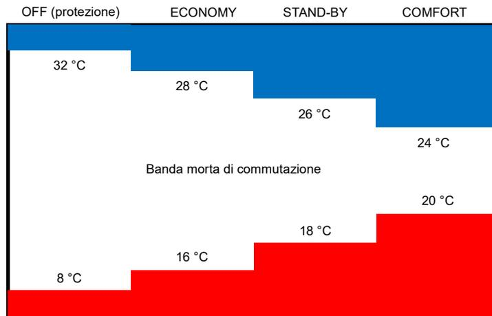
Figura 23 - Zona morta ed esempio di valori di setpoint coerentemente distribuiti
