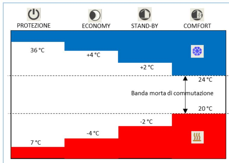
Figura 14 - Commutazione automatica in base alla temperatura ambiente
