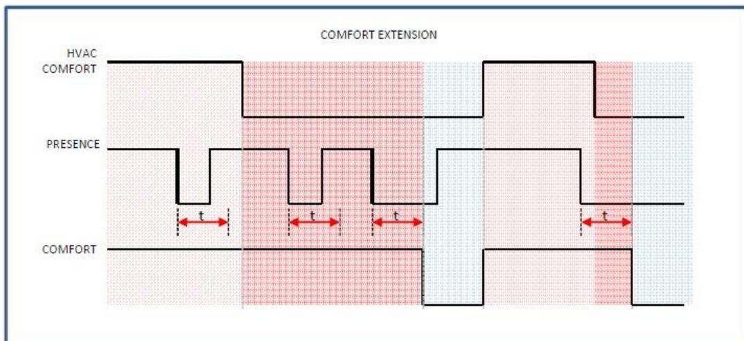
Figura 15 - Schema della funzione di prolungamento del comfort
