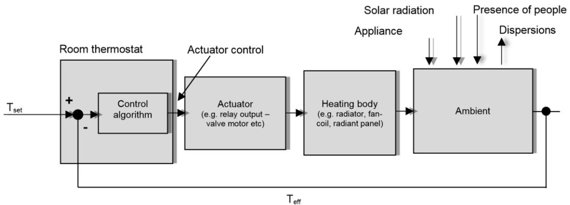
Figura 10 - Sistema di controllo per temperatura ambiente
