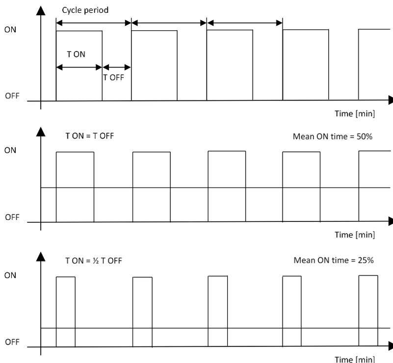
**Figura 13 – Schema regolatore PWM**
