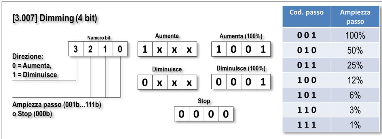
Figura 4 – OC tipo dimming
