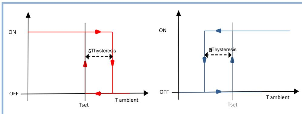
Figura 12 - Controllo temperatura a 2 punti
