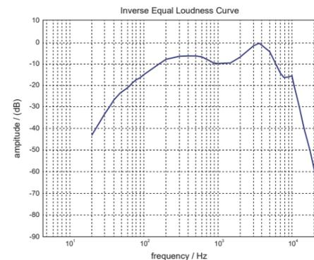
Questa invece è la curva che ha ispirato la risposta in frequenza del sistema di trasmissione del dispositivo EK-DW1-AU, che funziona come un "compensatore fisiologico di volume".
