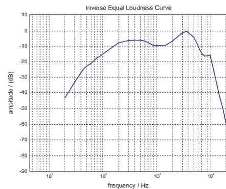
Questa invece è la curva che ha ispirato la risposta in frequenza del sistema di trasmissione a trasduttori di energia acustica ekinex®, che funziona come un "compensatore fisiologico di volume".
