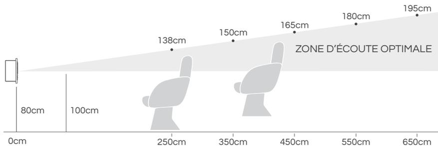
En ayant le bas de l'enceinte à 80cm du sol, la hauteur minimale d'écoute est de 100cm. L'abaque ci-dessus donne la hauteur maximale d'écoute en fonction des distances de recul.
